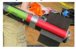
Figure 8: Redundant Drogue Pod
